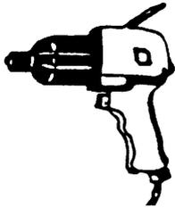
Bild 8.11 : Schlagschrauber mit Druckluftantrieb
